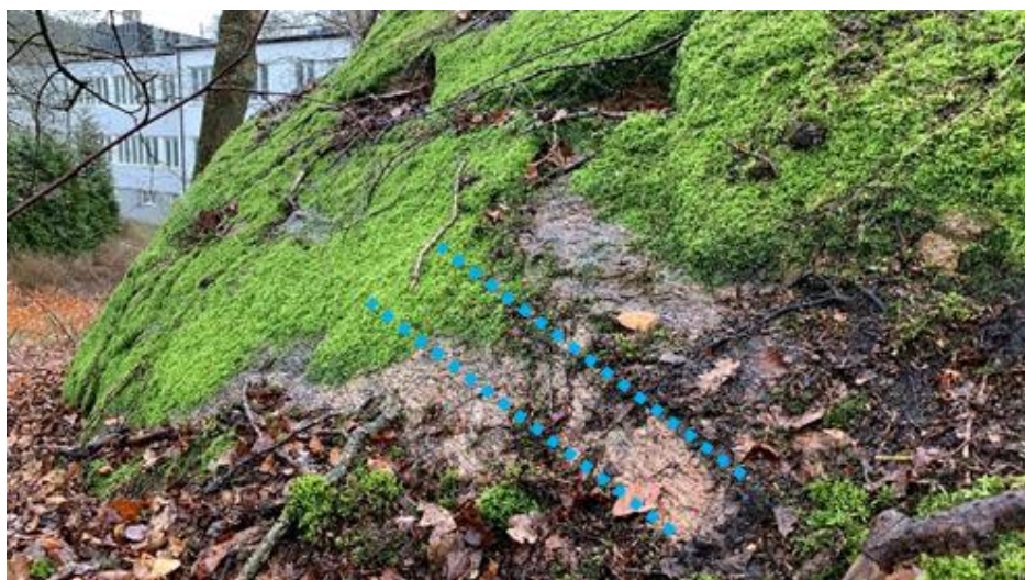
Figur 2. Streckade linjer i blått visar sprickriktningen för Spricka 3.
